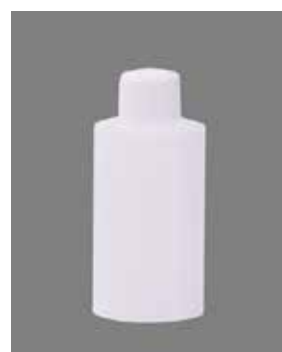
D-80 VOLUMEN: X 80 CC ALTURA: 86,5 mm DIAM. DE BASE: 41,5 mm DIAM. BOCA: 20 mm ● TAPAS DISPONIBLES: TP-01 | TP-07 | TP-19 | VP-20 VP-20-IMP | VP-20-E
